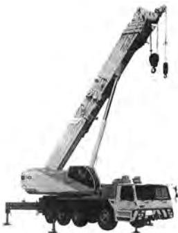
トラッククレーン
